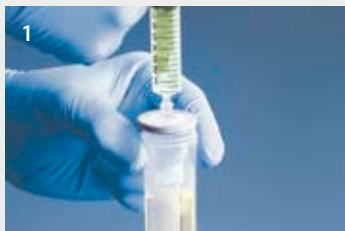
1. Stabile Auflage auf einem 50 ml Zentrifugenröhrchen
