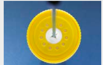
Wiederverschliessendes Septum mit Kreuzschlitz
